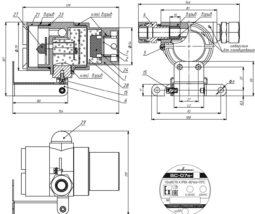
**1** – корпус; **2** – крышка; **4** – кабельный ввод; **5** – винт M4 заземления; **6** – кронштейн; **7** – сетка С-200; **15** – винт кронштейна; **21** – крышка; **23** – кольцо уплотнительное; **24** – сирена; **27** – плата клемм; **28** – компаунд; **29** – колба светового индикатора (для ВС-07е-И).
