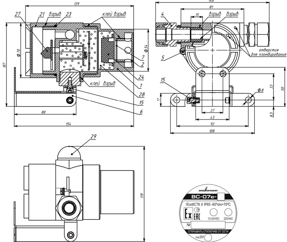
1 – корпус; 2 – крышка; 4 – кабельный ввод; 5 – винт М4 заземления; 6 – кронштейн; 7 – сетка С-200; 15 – винт кронштейна; 21 – крышка; 23 – кольцо уплотнительное; 24 – сирена; 27 – плата клемм; 28 – компаунд; 29 – колба светового индикатора (для ВС-07е-И).
