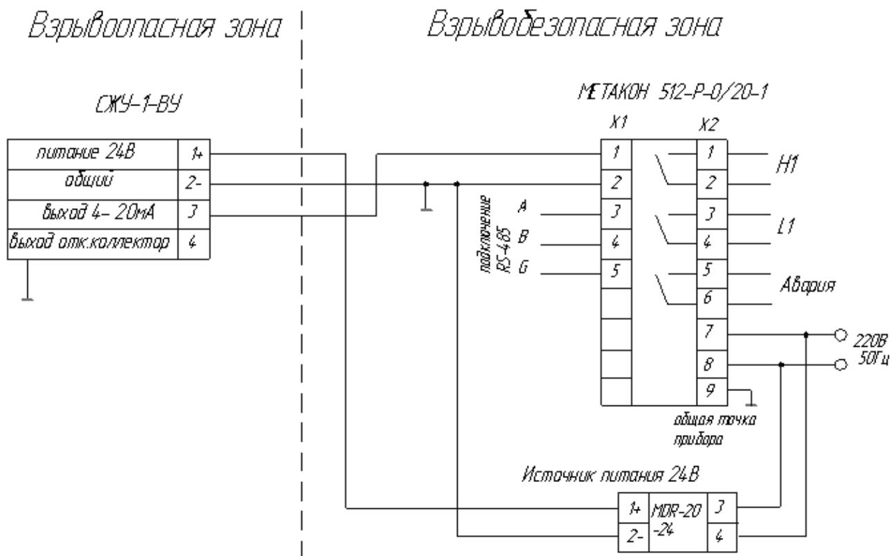
Рис.3. Схема подключения прибора
