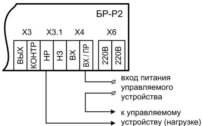
Рис.22 Схема подключения для функциональной проверки работоспособности БР-Р2
