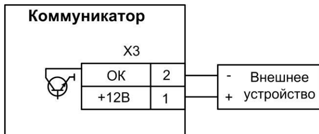
Рис.27 Схема подключения внешнего устройства к коммуникатору
