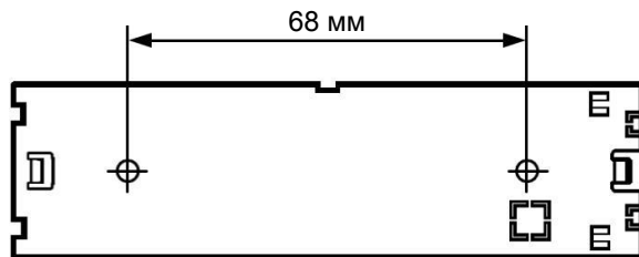
Рис.18 Основание Аква-Р2. Присоединительные размеры
