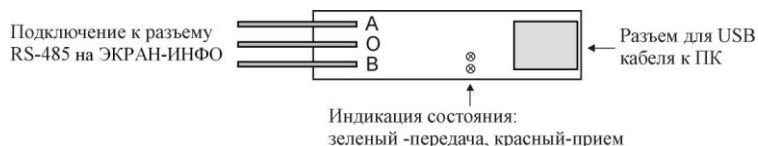
Рисунок 5. Расположение контактов преобразователя ПИ1.
