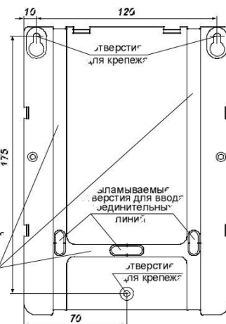
Рис.2 Основание. Присоединительные размеры
