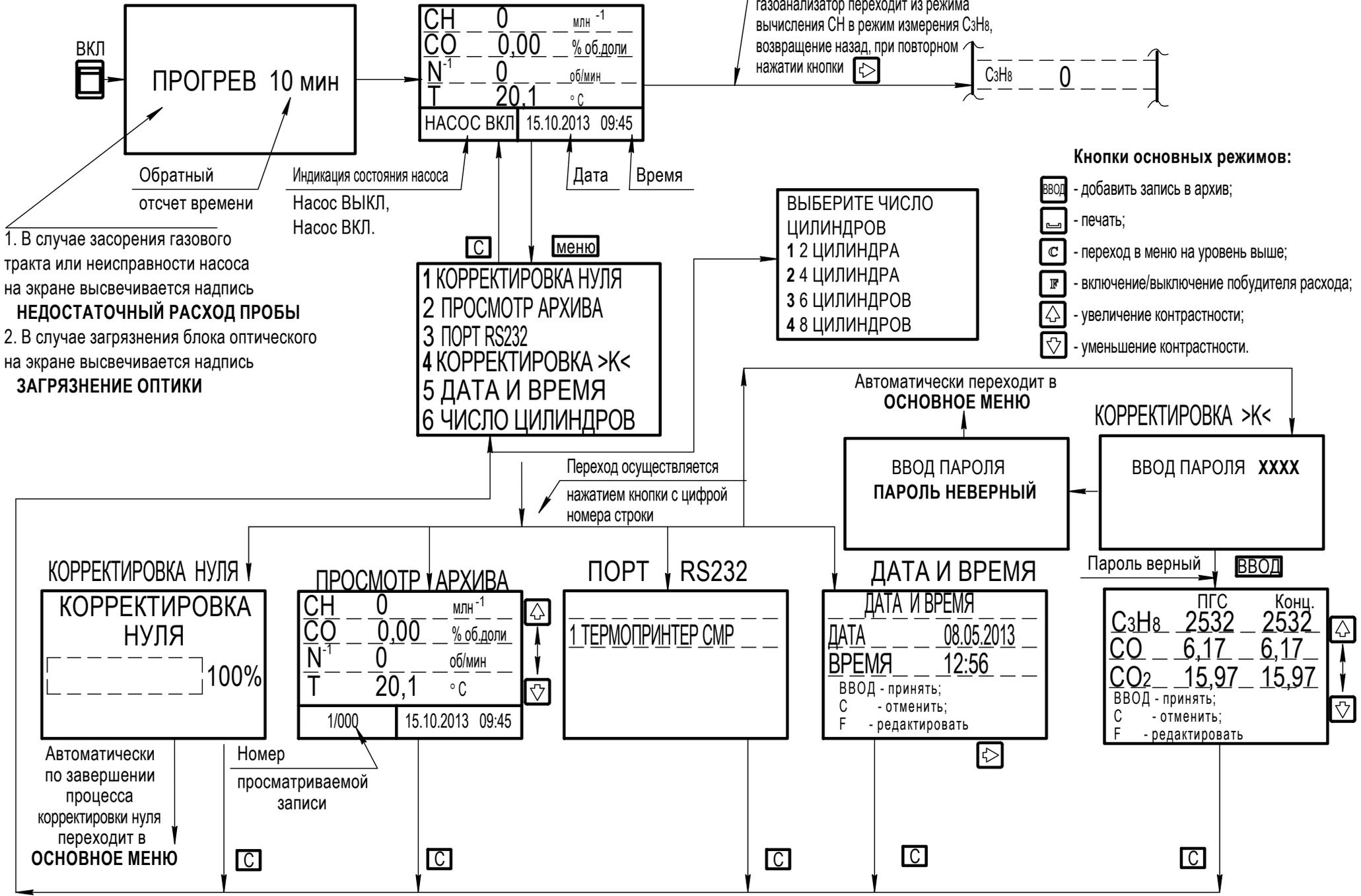
1. В случае засорения газового тракта или неисправности насоса на экране высвечивается надпись **НЕДОСТАТОЧНЫЙ РАСХОД ПРОБЫ**
