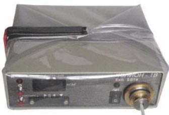
Для увеличения степени защиты газоанализатора от внешних воздействий используется защитная оболочка, выполненная из ПВХ материала. С защитной оболочкой поставляется специальное конструктивное исполнение газоанализаторов. Защитная оболочка используется в комплекте с сумкой-укладкой. Степень защиты от пыли и влаги газоанализатора в защитной оболочке – IP67.
