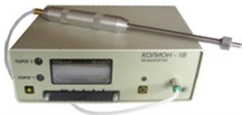
Газоанализаторы КОЛИОН-1В-26 предназначены для измерения содержания в воздухе рабочей зоны паров углеводородов нефти и нефтепродуктов (кроме метана, этана, пропана), органических растворителей, спиртов (кроме метанола), альдегидов (кроме формальдегида), три- и тетрахлорэтилена, аммиака и других компонентов, контроля дозврывоопасных концентраций углеводородов, начиная с метана, а также селективного измерения оксида углерода (СО) и кислорода (О<sub>2</sub>).
