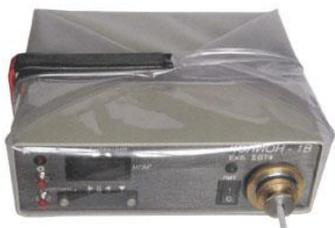
Для увеличения степени защиты газоанализатора от внешних воздействий используется защитная оболочка, выполненная из прозрачного и матового ПВХ материала. С защитной оболочкой поставляется специальное конструктивное исполнение газоанализаторов.. Защитная оболочка используется в комплекте с сумкой-укладкой. Степень защиты от пыли и влаги газоанализатора в защитной оболочке – IP67.
