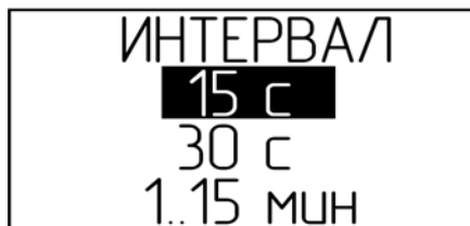
Рисунок 2.9 – Меню выбора интервала записи в архив газоанализатора
