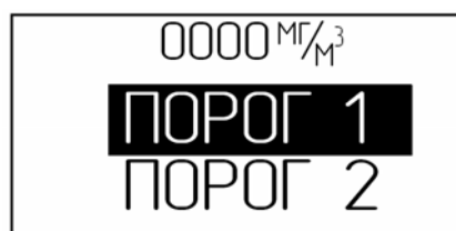
Рисунок 2.5 – Меню выбора редактируемого порога срабатывания сигнализации (редактируемый порог выделен инвертированием символа).
