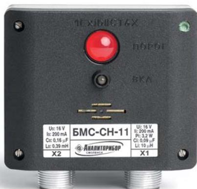
Предназначен для работы совместно с датчиками-газоанализаторами ДАТ-М, ДАХ-М и обеспечивает выдачу световой и звуковой сигнализации при достижении выходным токовым сигналом с датчика фиксированного порога срабатывания.
